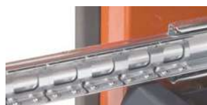
Телескопічні направляючі на шарнірах
