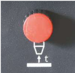
Функція «Прогар» видаляє кульки на кінці зварювального дроту і забезпечує чистий запуск зварювання
